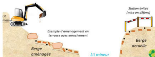
Etape 5/6 : Exemple 2 : Aménagement en terrasse et ré-étalement des terres favorables à la Consoude bulbeuse
