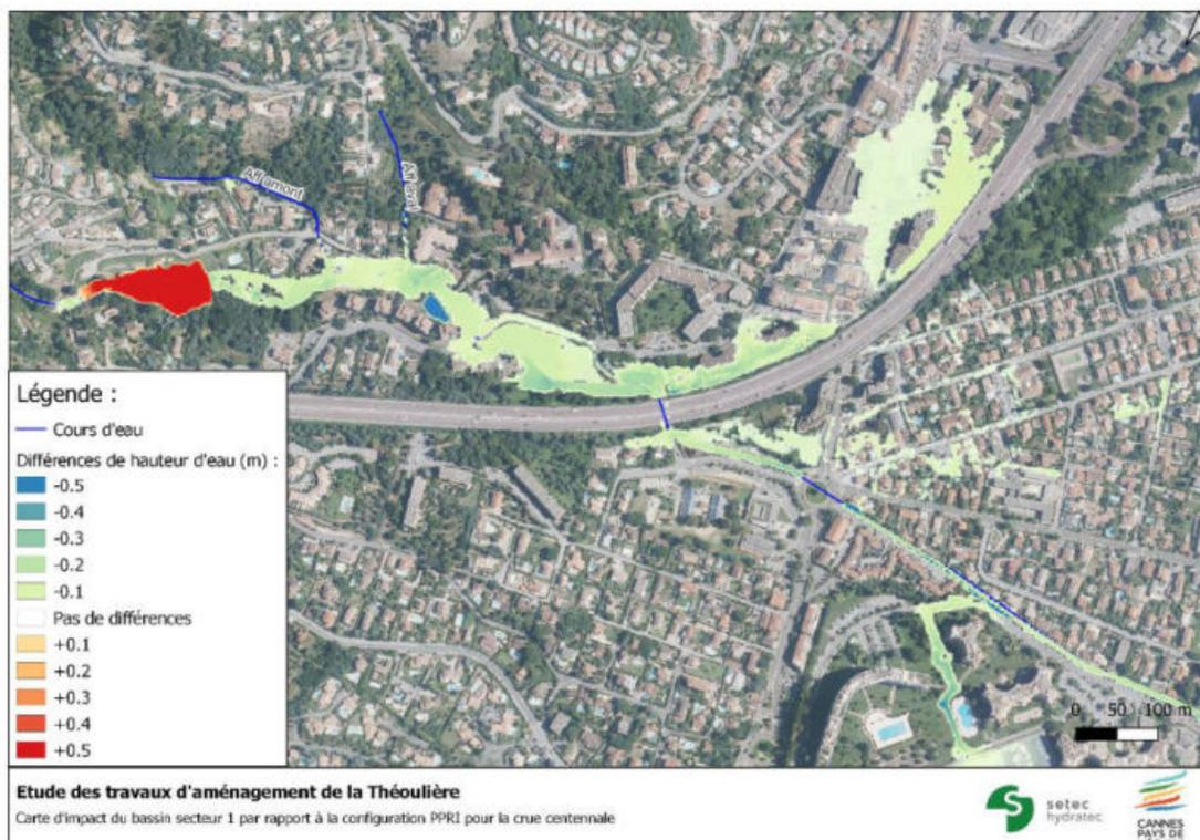
Figure 4-22 : Carte d'impact de la construction du bassin du SMIAGE sur les hauteurs d'eau pour la crue centennale
