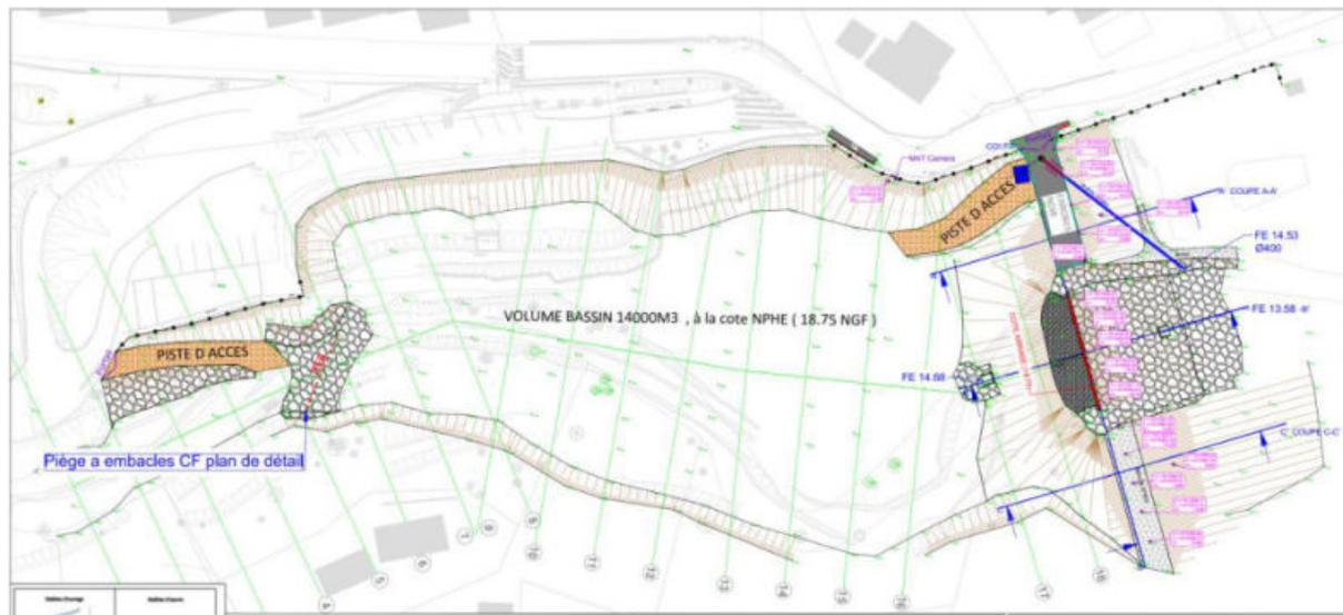
Figure 4-1 : Vue en plan du bassin du SMIAGE [Source : plan de Récolement – GUINTOLI 2023]
