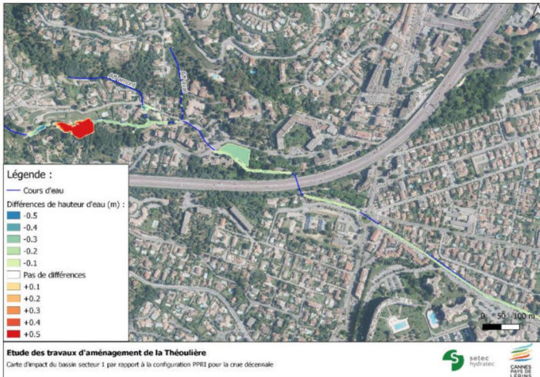
Figure 4-21 : Carte d'impact de la construction du bassin du SMIAGE sur les hauteurs d'eau pour la crue décennale
