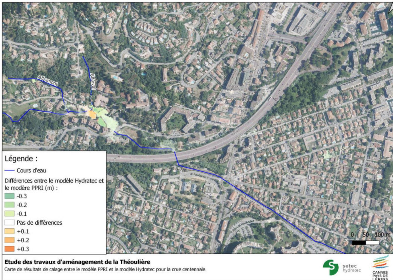
Figure 3-8 : Carte de résultat de calage du modèle hydraulique
