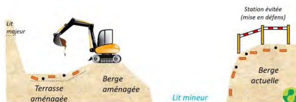
Etape 5/6 : Exemple 3 : Aménagement d'une terrasse d'expansion et ré-étalement des terres favorables à la Consoude bulbeuse
