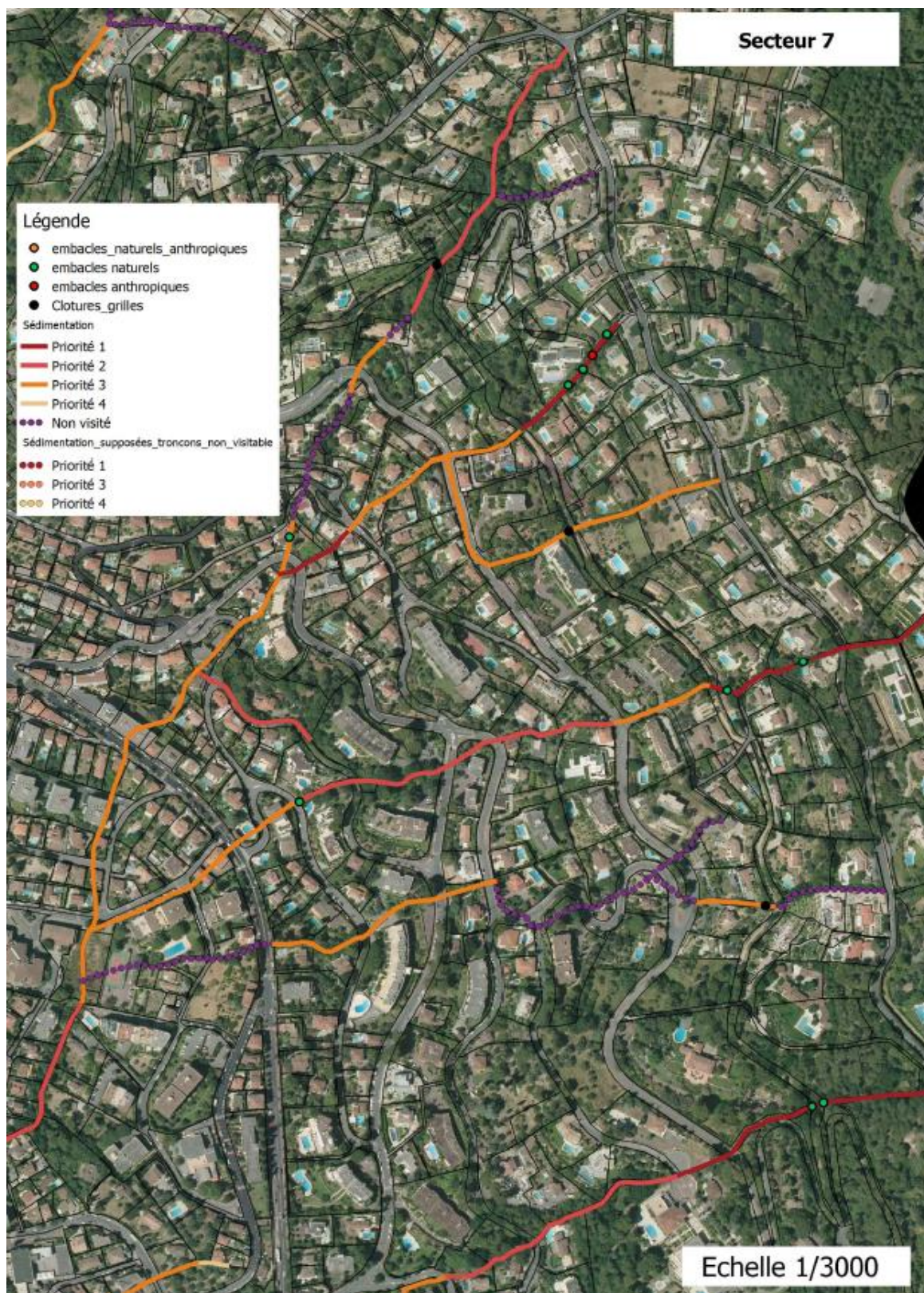
Figure 40 : Embâcles et niveau de sédimentation – Diagnostic du secteur 7
