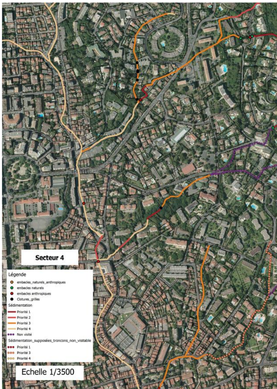
Figure 37 : Embâcles et niveau de sédimentation – Diagnostic du secteur 4
