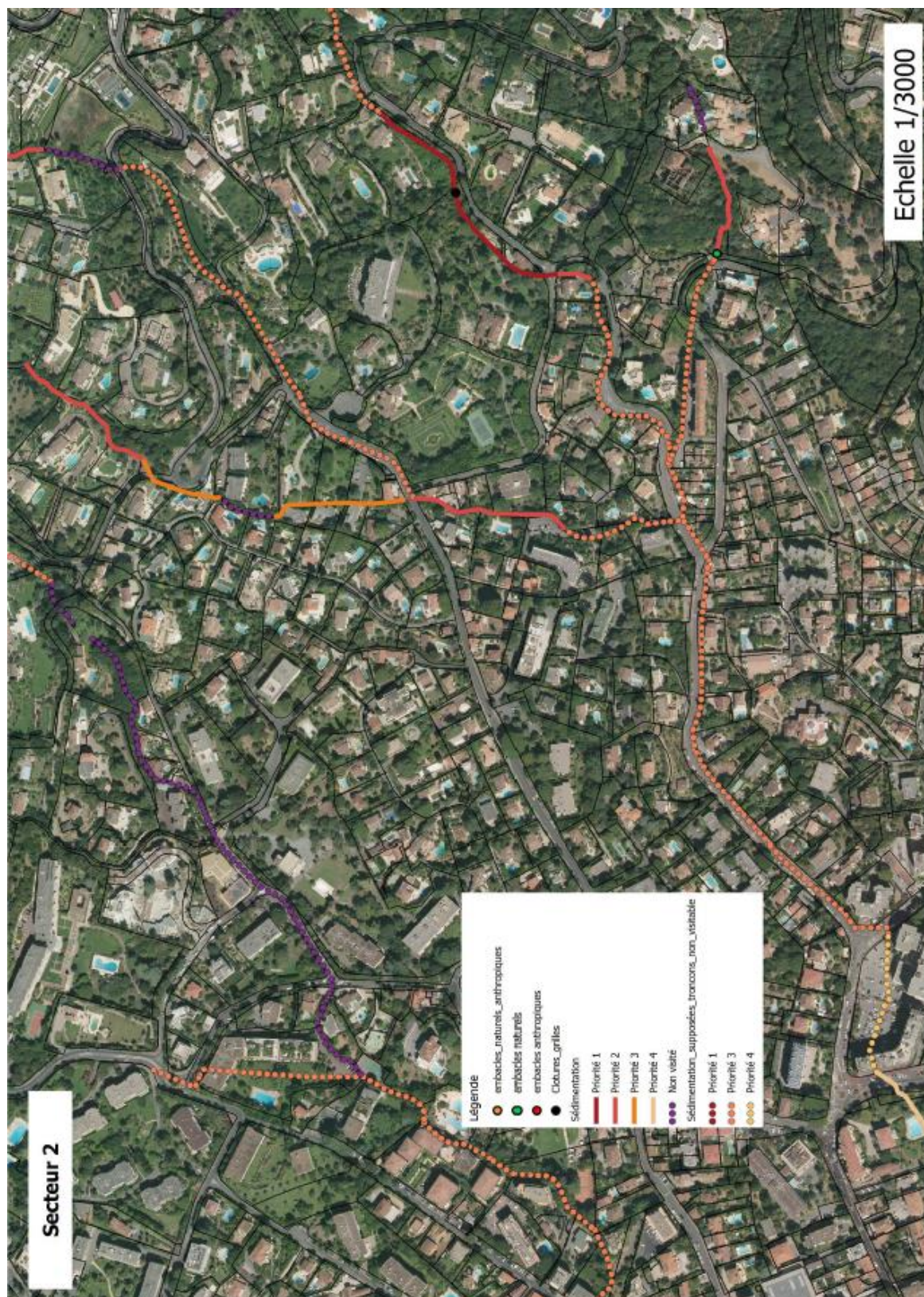
Figure 35 : Embâcles et niveau de sédimentation – Diagnostic du secteur 2
