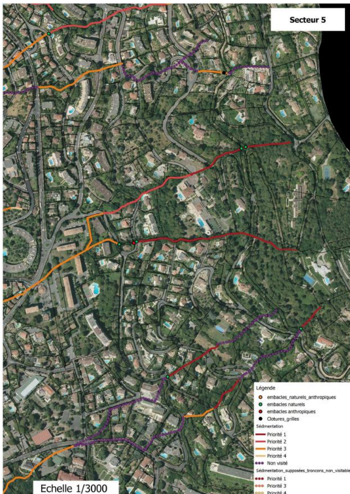
Figure 38 : Embâcles et niveau de sédimentation – Diagnostic du secteur 5
