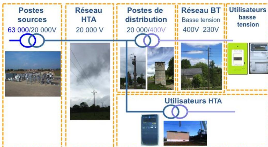
Figure 54 - Rappel des grands ouvrages du réseau électrique - Hespul
