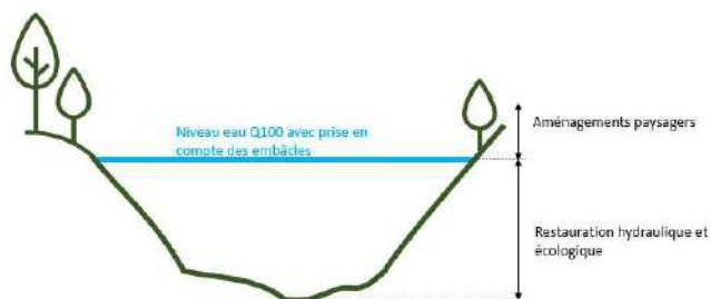
Figure 57: Schéma de principe – limite aménagement paysager / restauration du cours d'eau
