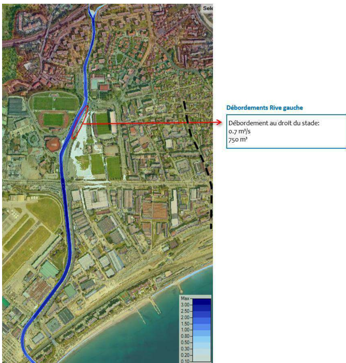
Figure 40: Résultats état projet scénario 1 – sans embâcle – Hauteur maximale crue centennale
