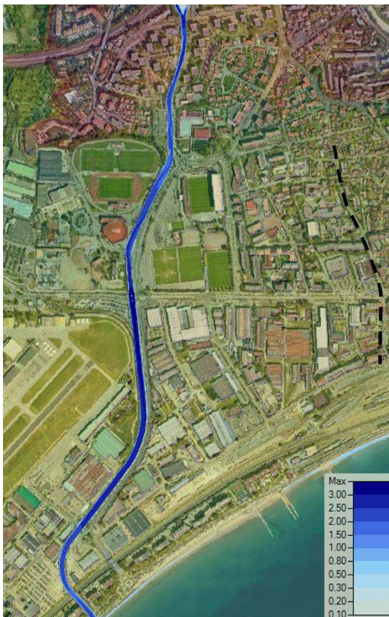
Figure 44: Résultats état projet scénario 2 – sans embâcle – Hauteur maximale crue centennale
