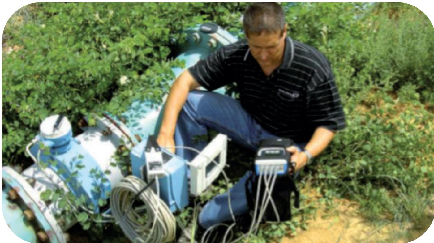
**En 2024, l'Agglomération Cannes Lérins a fait procéder au contrôle des dispositifs d'autosurveillance des points caractéristiques du réseau par un prestataire agréé indépendant, selon les mêmes critères que ceux du contrôle réglementaire.**
